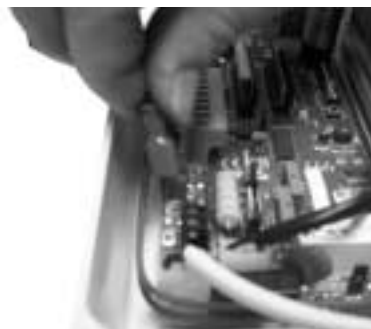
Déconnecter les câbles du moteur du KS SUPER
