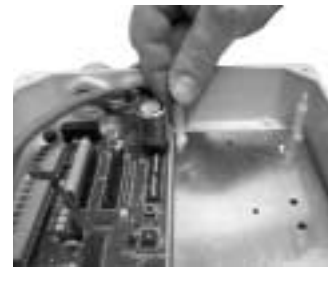
4 Distanzstücke in die vorgesehene Löcher der Kunststoffhalterung einsetzen
