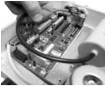
Trennen Sie ab und entfernen Sie den Kondensator
