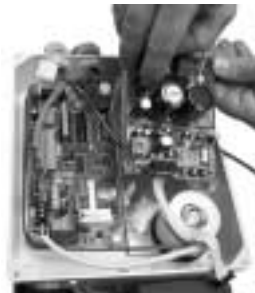
Der Inverter in die 4 Distanzstücke einsetzen.
