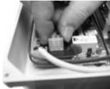
Das Schutzgehäuse auf dem J17 entfernen.
