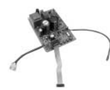
Der Inverter wird samt den Leistungs- und Logikkabeln zur Verbindung zu der KS SUPER geliefert.
