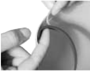
Installation der Dichtung
